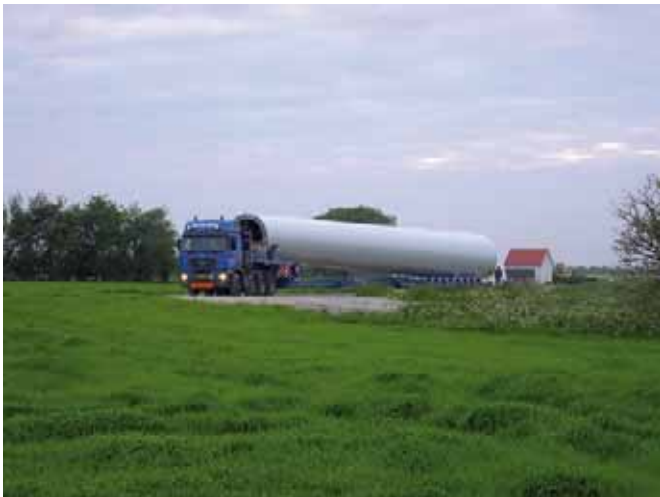
Billede af tårn på blokvogn (Foto: Niels Mejlholm)
